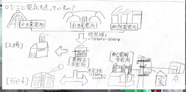
電気は貯めておくことができません。スイッチを入れたと同時に 流れて来るのは、今この瞬間に作られた電気です。作られた電気です。作られたではかいの電気は電圧がとても高く、電流を では使用できません。その電では、少しずるのです。 を下げて、家庭に送るのです。 をの回では、そのリレー方式を絵で表しています。
