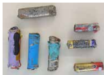
火災発生時に発見された乾電池、リチウムイオン電池
