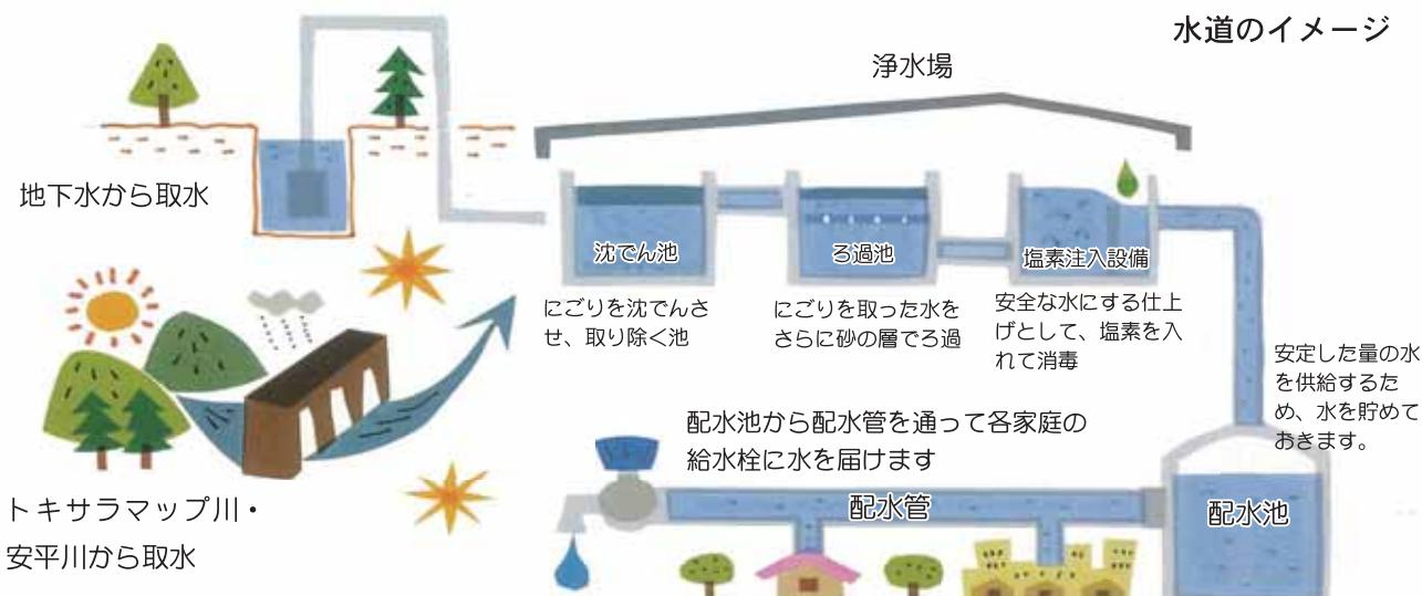
地下水や川から取水したばかりの水は、浄水場できれいになるまで浄水処理をしてるんだよ。
