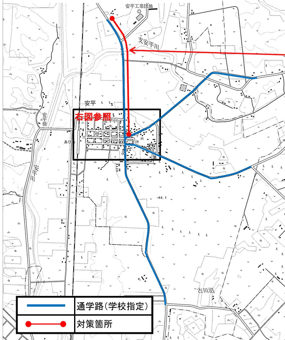
①安平工業団地付近から追分側は歩道が無く、大変危険な状況。また、歩道がある区間についても、大型車輛などの交通量が多い上に追い越し可能区間となっているため、法定速度を上回るスピードで追い越しをする車輛も多く、冬季間はスリップをして路外に飛び出す事故も起きているため大変危険が状況。
