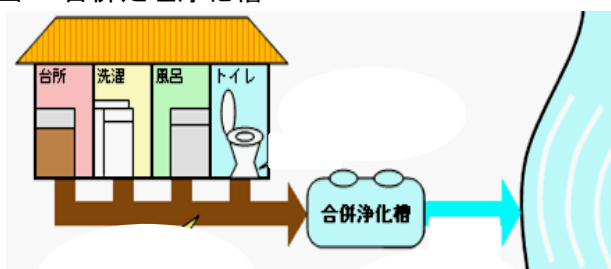
図1 合併処理浄化槽
