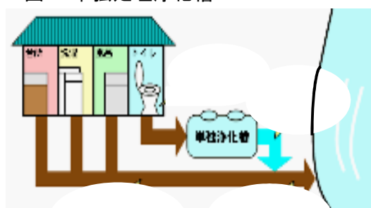
図2 単独処理浄化槽
